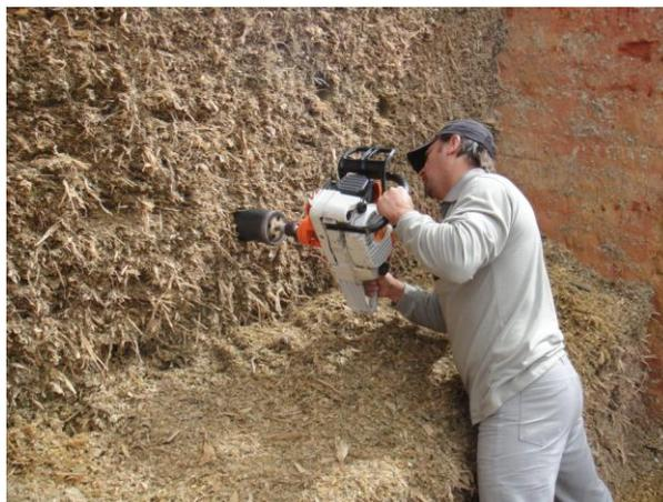
Figura 1 – Processo de amostragem com utilização do cilindro metálico acoplado à uma motosserra.
